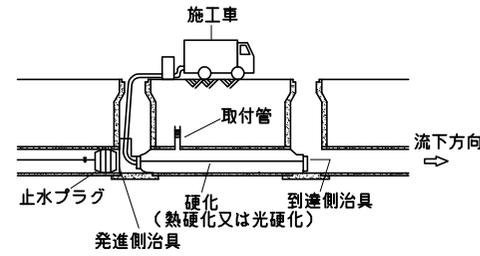
管口処理工詳細図
