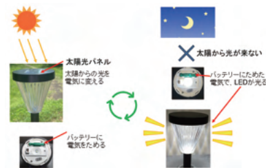
太陽光に光を当てて電気を作り、 バッテリーにためる。
