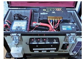
手作りソーラー発電システムの内部
