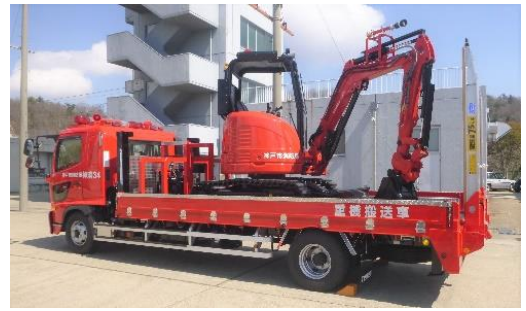
重機搬送車に積載した重機
