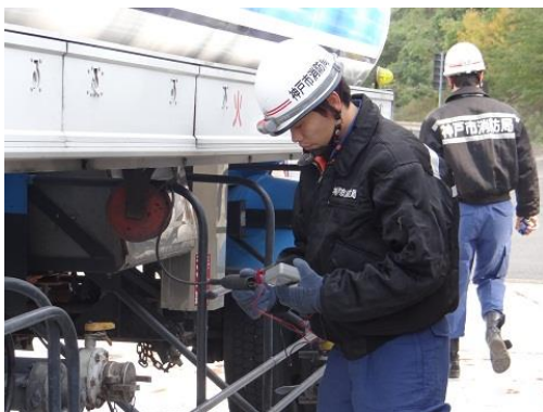
移動タンク貯蔵所の立入検査
