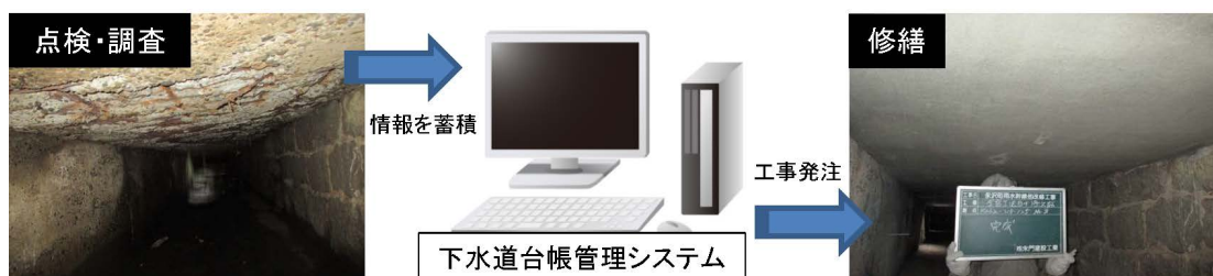
図 管きよの点検・調査、修繕の流れ
