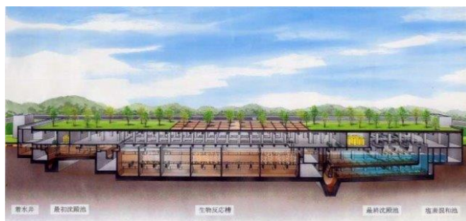
図 高度処理施設の導入事例（垂水処理場）
